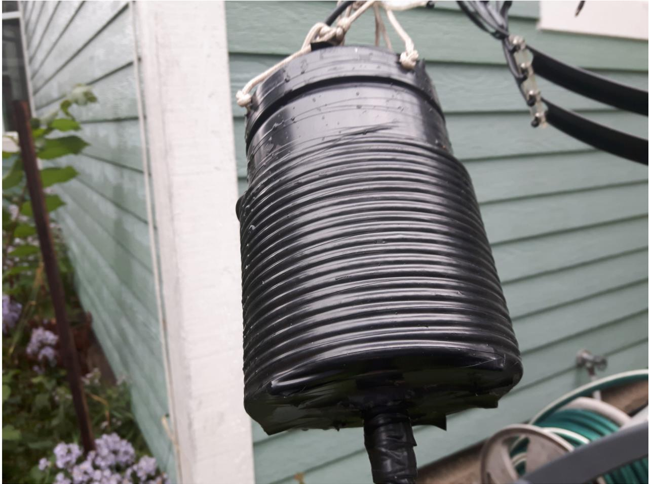
Balun courant (current choke) 22 tours de RG58 sur une forme cylindrique non conducteur d'environ 6 po. de diamètre.
